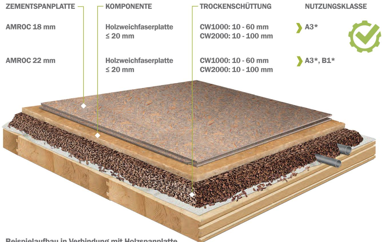
Beispielaufbau in Verbindung mit Holzspanplatte
