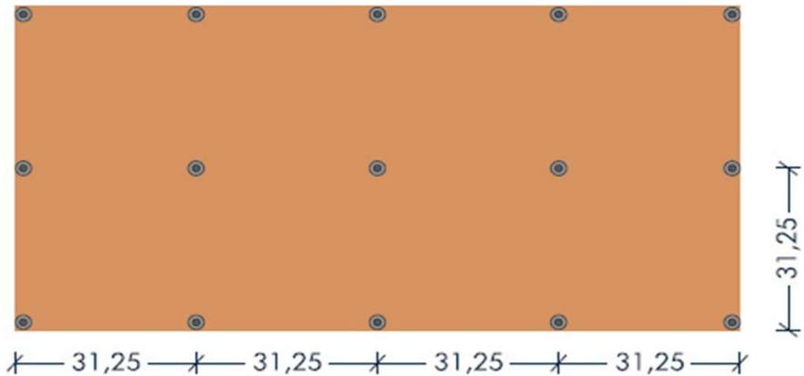
**Darstellung Plattenversatz, Halteteller HV36 am Plattenrand:**
