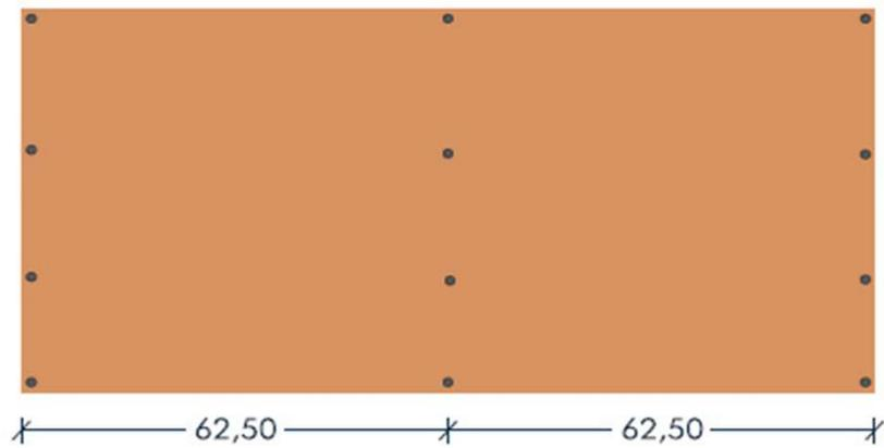
**Befestigungsschema L16 / L22 Decke (mit Halteteller HV36):**
