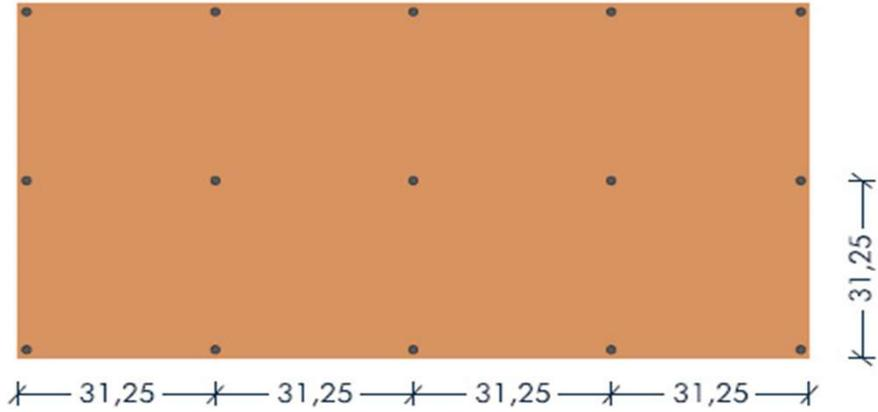
**Befestigungsschema L22 Wand mit Schrauben:**
