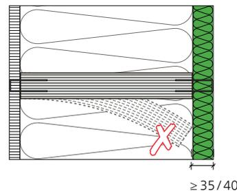
Stabilisierter Querschnitt mit  $H/B > 4/1$  durch *STEICOuniversal* oder *STEICOprotect H*
