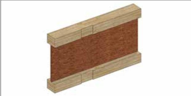
Für eine einfache und passgenaue Positionierung von Wechsel und Wandstützen bietet die europäische Technische Bewertung der Stegträger die Möglichkeit, seitliche Kerben in die Stegträgergurte aus Furnierschichtholz zu schneiden.
