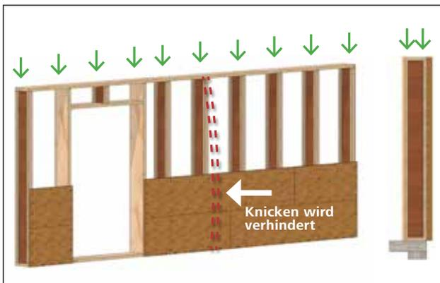
Erstmals können Holzfaser-Dämmplatten nach dem Naßverfahren zur Aussteifung der Konstruktion mit angesetzt werden. Möglich macht das die bauaufsichtliche Zulassung abZ Z-9.1-826 für die STEICO Dämmplatten *STEICOuniversal* und *STEICOprotect H*. Für Holzbaubetriebe eröffnen sich damit neue Konstruktionsmöglichkeiten und Absatzchancen, z.B. bei der Vorfertigung diffusionsoffener Ausbauhäuser.
