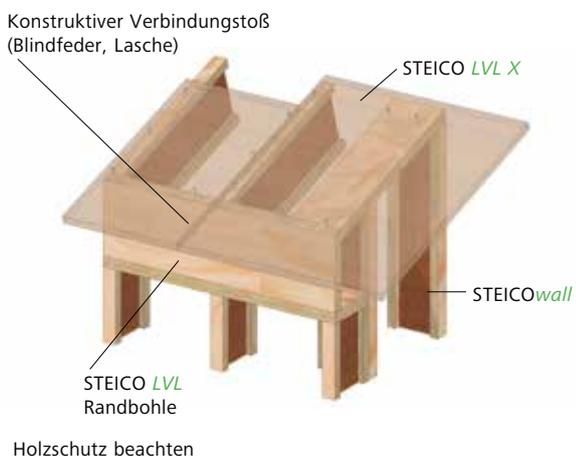
**D12 Aufdachdämmung – Aufdoppelung mit STEICOwall**
