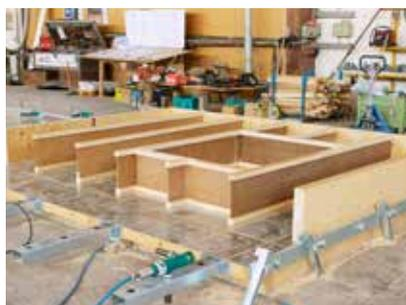
STEICOWall Stegträger bilden das Tragwerk der Wände. Der Elementrahmen besteht aus STEICO LVL R.
