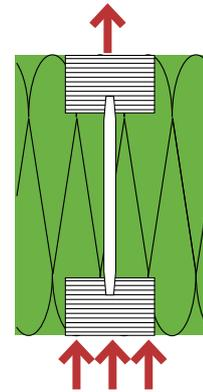
Prinzip der vergleichbaren Vollholzbreiten. Statt eines Stegträgers wird ein deutlich schmalere Vollholzquerschnitt bemessen ( $b_{vergl.}$ ).
