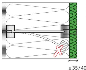
Stabilisierter äußerer Stegträgergurt durch *STEICOuniversal* oder *STEICOprotect H*
